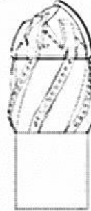
FIG. 7.5 * Nasos-kompresor borularn üçün başmaq * sənaye nümunesinin ön tərəfdən görünüşü
